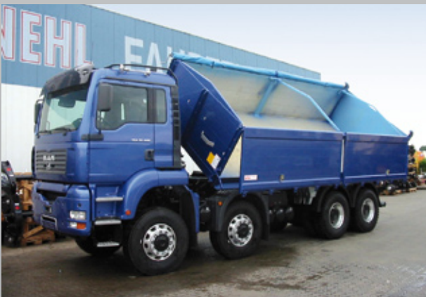
3-Seiten-Kippaufbau m. geteilten Alu-Bordwänden
